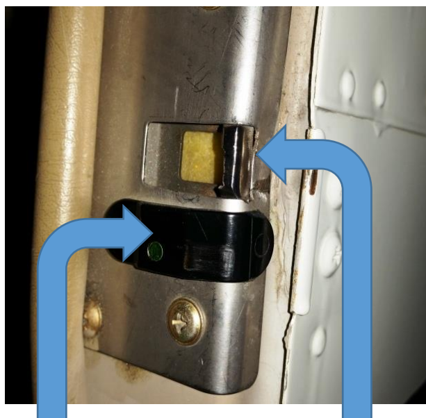
Plastledare för utlösning av styrtappen - Låsbleck i dörrkarmen
